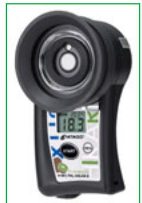
**(segue) Metodo rifrattometrico – Rifrattometri IR digitali portatili PAL-HIKARI**
